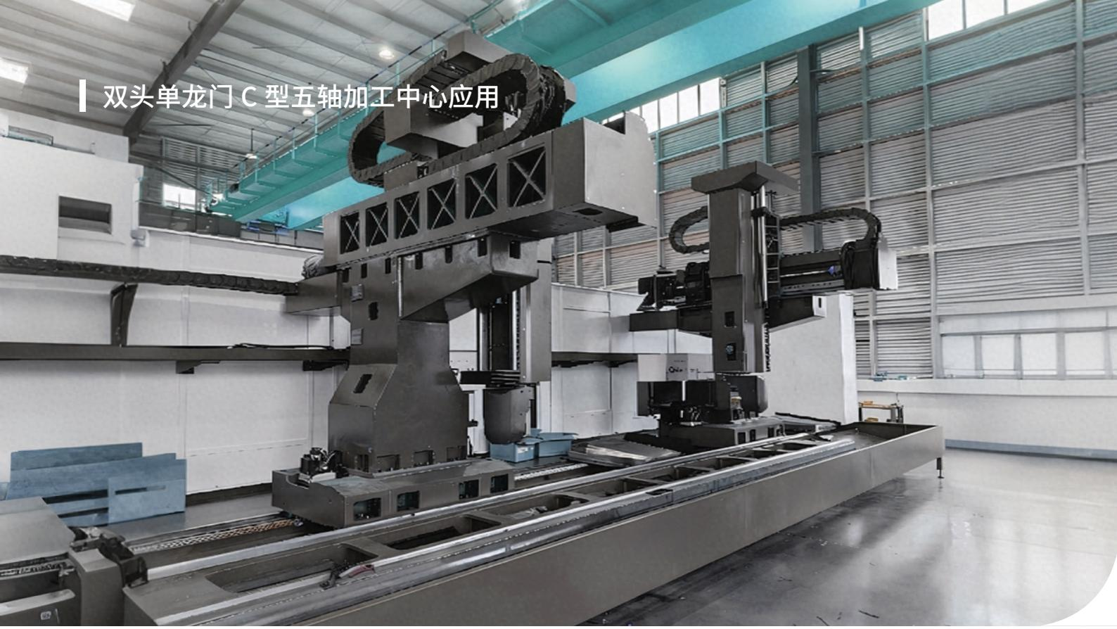
双头单龙门C型五轴加工中心由双 OPENsmart 控制，实现了双头的 RTCP (刀具中心点控制)。它既可以在两个工作台上分别生产，也可以协同加工同一工件。这有效提高了工作台的利用率，并支持加工产品尺寸范围广泛。Z 轴重量减轻和 AC 轴空气制动控制提高了 Z 轴的反应速度和 AC 轴在重切削加工场景中的优异性能。
